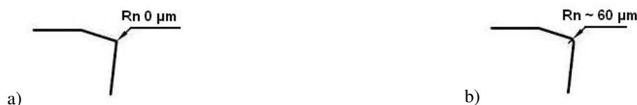
Figura 11. Aresta de corte do chanfro-T das lâminas de PCBN: a) atual; e b) proposta de modificação, Rn de aproximadamente 60 \mu\text{m} .
