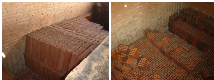
Figura 3. O Lado direito mostra à arrumação dos lotes de telhas no forno, e o lado esquerdo a arrumação dos lotes de tijolos.
