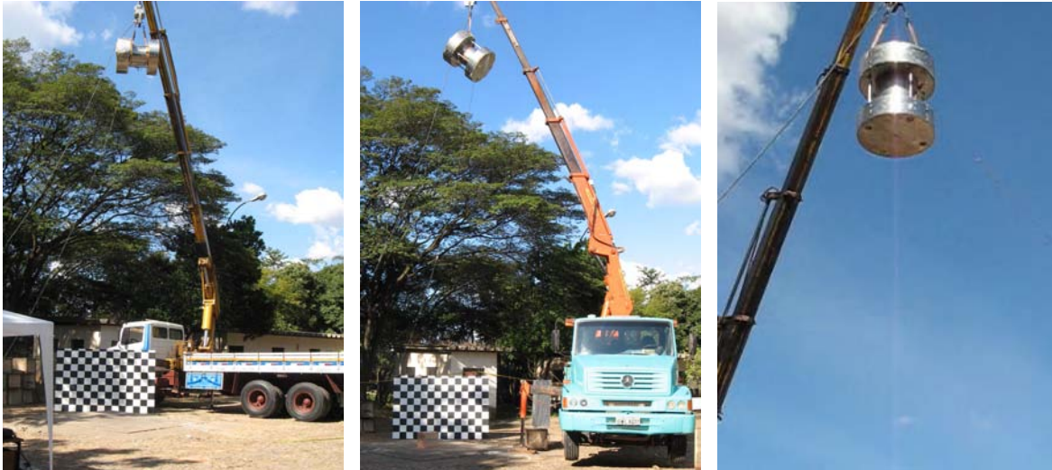
Figura 7. Posições de queda de 9m: (a) Horizontal; (b) Inclinada ( 42,9^\circ ) e (c) Vertical.
