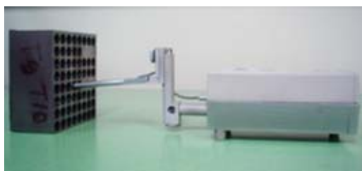
Figura 3. Rugosímetro utilizado na medição da rugosidade superficial.
