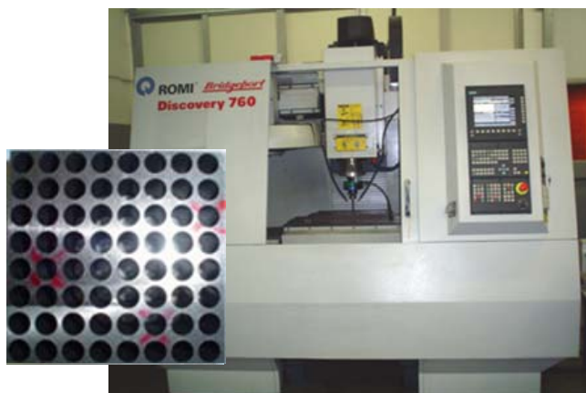
Figura 1. Centro de usinagem vertical CNC utilizado nos testes de furação e uma peça de ferro fundido furada, em detalhe.
