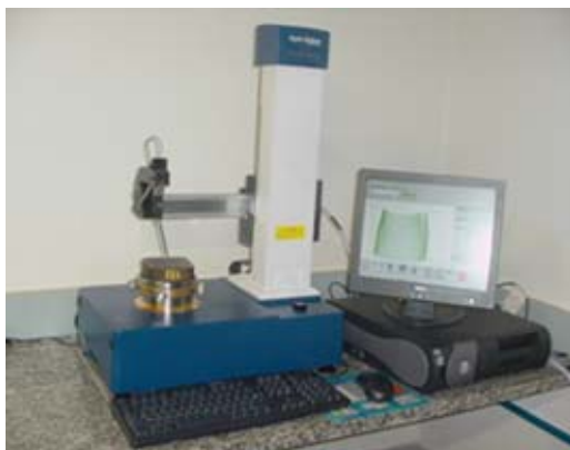
Figura 2. Máquina de medir desvios de forma modelo Talyrond 131 (Taylor Hobson).
