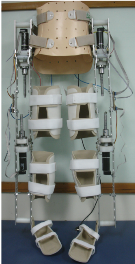
Figura 3. Imagem do protótipo da órtese ativa para membros inferiores desenvolvida pelo grupo de Robótica e Sistemas Dedicados do DCA/UFRN.
