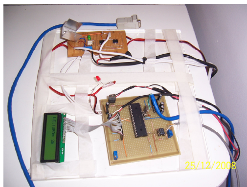
Figura 10. Circuitos acoplados de acionamento e controle com microprocessador para motor AC.
