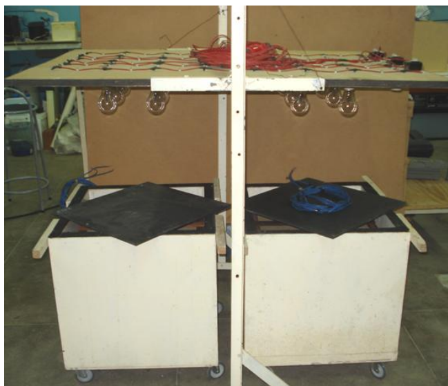
Figura 2. Câmaras de ensaios de desempenho térmico de telhas.
