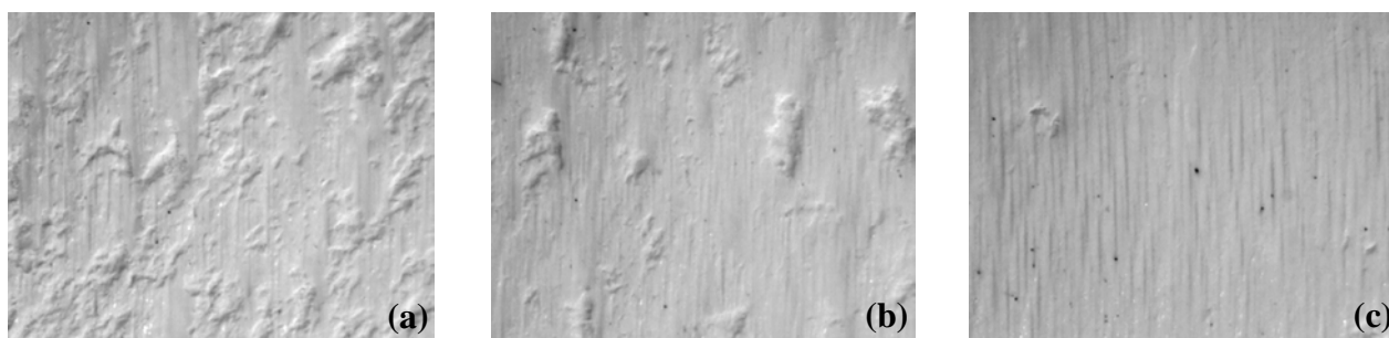
Figura 3. Superfícies de corpos-de-prova usinados em verde com acabamento considerado inadequado (a), parcialmente adequado (b) e adequado (c).
