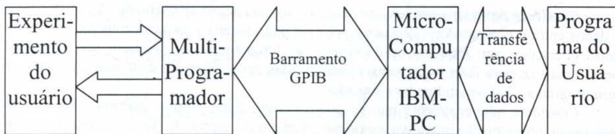
Figura 1 - Exemplo do sistema típico de um experimento controlado e/ou monitorado por um multiprogramador.
