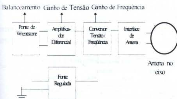
Figura 2- Torquímetro eletrônico no eixo
