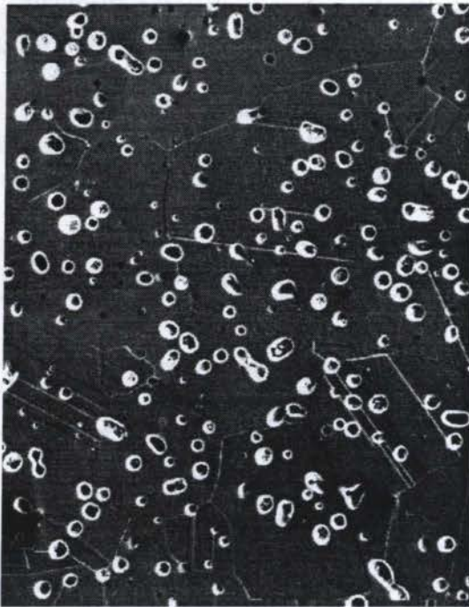
Figura 3 - Amostra 06C/12 AISI 316L, sinterizada por plasma com ciclo de 1270 °C por 60 minutos - MEV 400x.
