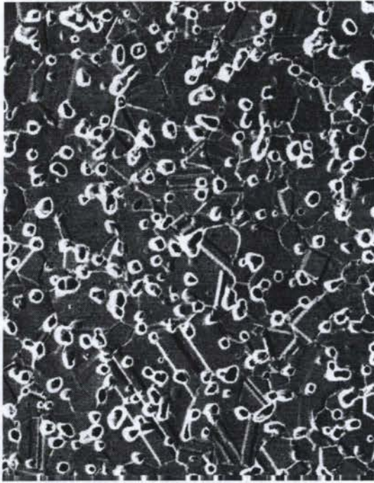
Figura 1 - Amostra 02A/14 AISI 316L, sinterizada por plasma com ciclo de 1050 °C por 60 minutos - MEV 400x.
