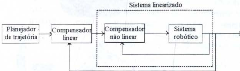
Figura 2 – Estrutura do sistema de controle
