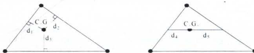
Figura 5 - Margem de estabilidade ( S_m = \text{mínimo de } d_1, d_2 \text{ e } d_3 ) e margem de estabilidade longitudinal ( S_l = \text{mínimo de } d_4 \text{ e } d_5 ) do polígono de suporte [2].
