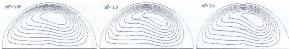
Figura 3 - Linhas de corrente do escoamento secundário da composição água / querosene.
