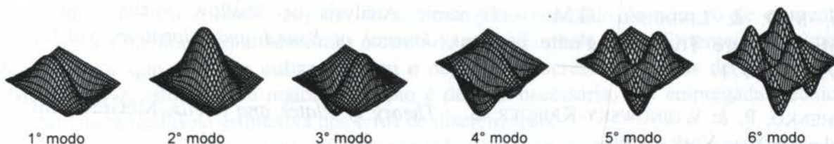
Figura 11 - Modos de vibrar da casca cilíndrica EEEE e malha regular de 7 \times 7 elementos, obtidos a partir do elemento da família Lagrangiana.
