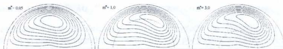
Figura 7 - Linhas de corrente do escoamento secundário da composição querosene / água.
