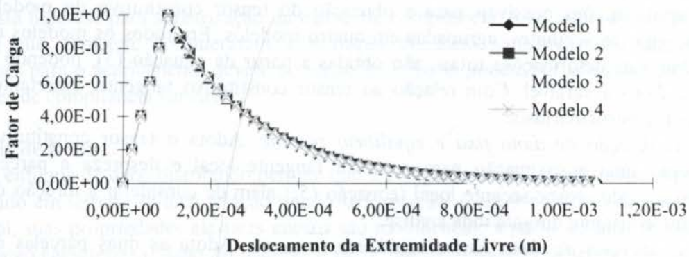
Figura 2 - Resultados do Exemplo para o ensaio de tração
