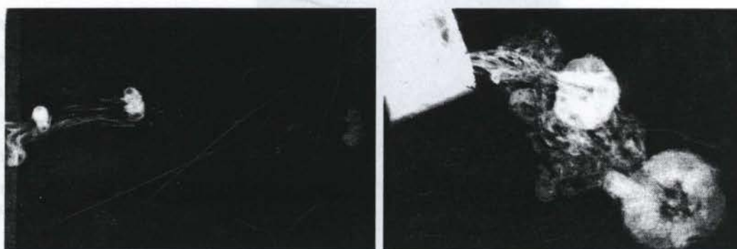
Figura 6: Vórtice anelar gerado com alto-falante pequeno, com Re = 1650
