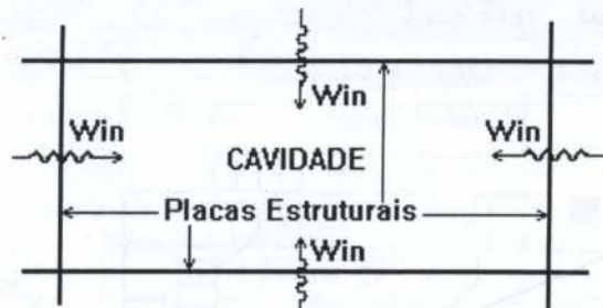
Figura 2 - Esquema de uma cavidade indicando as contribuições das superfícies adjacentes para o ruído gerado
