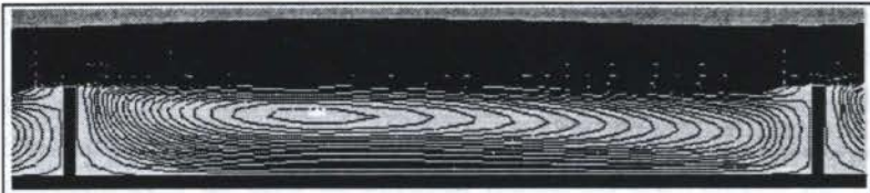
Fig.3 - Configuração das linhas de corrente para o intervalo entre duas aletas curtas.
