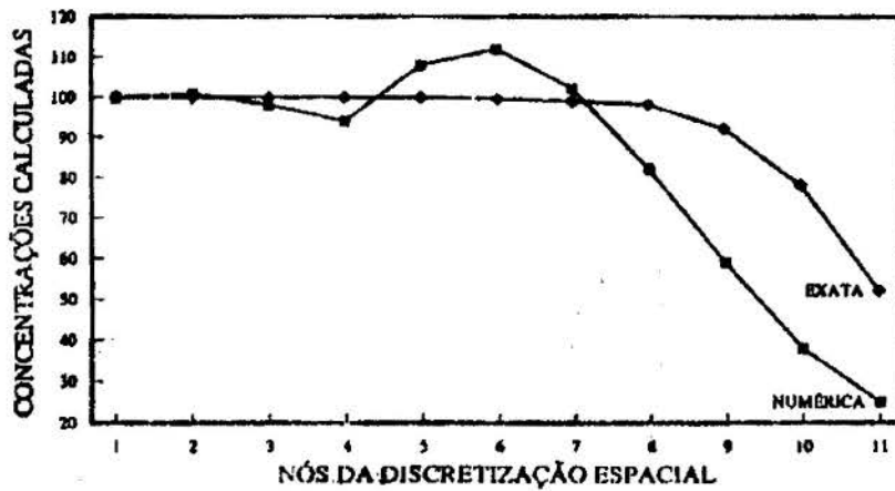
Figura 2: Campo solução em t = 5\Delta t ( Pe=10; Cr=2 )
