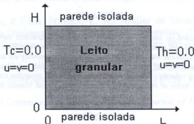
Figura 1 - Geometria e condições de contorno do problema
