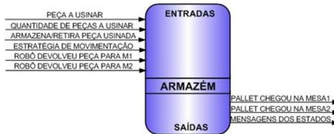
Figura 5. Interfaces do armazém automático
