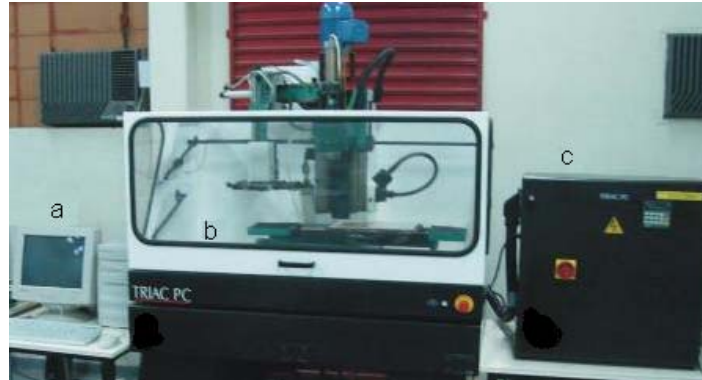
Figura 1. O mini centro de usinagem: (a) o computador responsável pelo controle, (b) a fresadora CNC e seu trocador automático de ferramentas e (c) o painel eletroeletrônico de acionamento.
