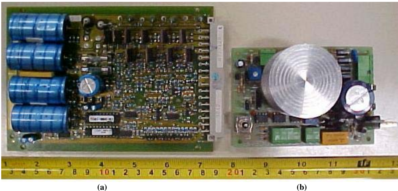
Figura 7. Drivers dos motores de passo: (a) o original e (b) o atual, Bonacorso et al. (2008).
