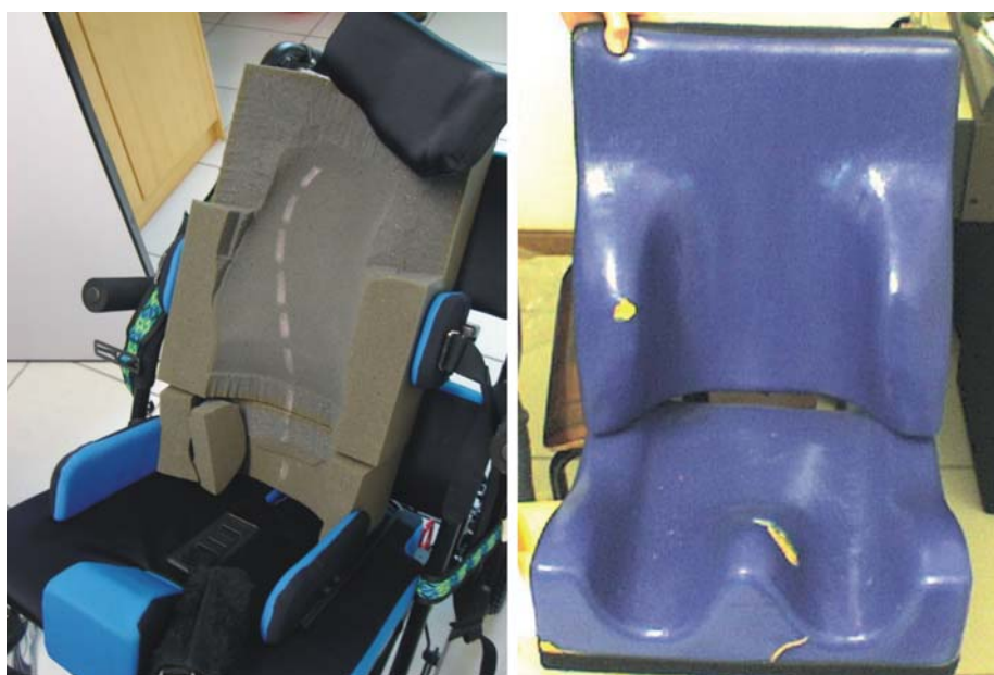
Figura 5. Espuma personalizada sem acabamento montada para teste em cadeira de rodas (A) comparada com espuma padrão sem personalização (B).
