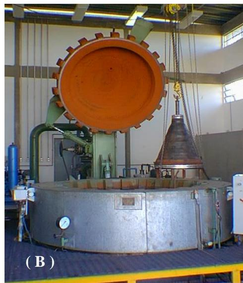
**Figura 1 – Autoclave (A) e Hidroclave (B) utilizados em processos de moldagem de compósitos poliméricos.**
