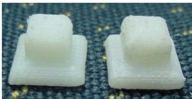
Figura 20. As duas peças fabricadas pelo equipamento FDM.
