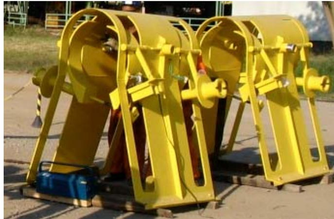
**Figura 8. Estrutura das braçadeiras de um suporte mecânico tradicional.**
