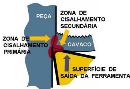
Figura 3. As diferentes zonas de formação do cavaco.
