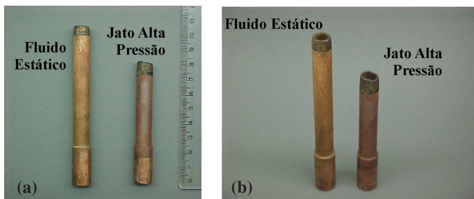
Figura 9. Desgaste das ferramentas nos ensaios com água deionizada e com adição de abrasivo: (a) vista 1 e (b) vista 2.
