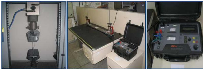
Figura 2. Equipamentos para a Caracterização Mecânica [KRATOS] e Elétrica [Micro homímetro].
