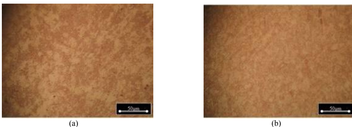
Figura 11 – Micrografia da amostra 5 – exposto a temperatura de 136°C (a) – transversal, e (b) – longitudinal.
