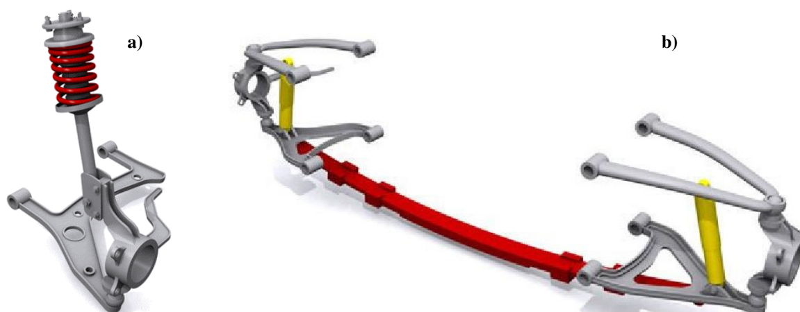
Figura 1. Molhas usadas na suspensão dianteira: a) Mola helicoidal no sistema MacPherson, e b) Molhas parabólicas transversais, The Suspension Bible (1998).
