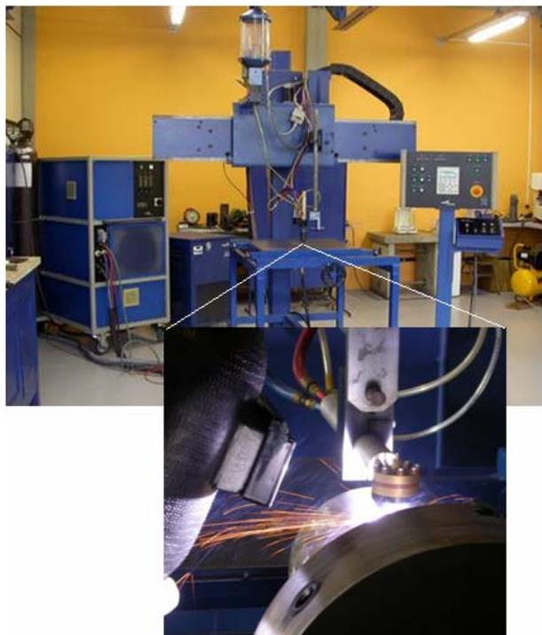
**Figura 1. Equipamento do PTA no Laboratório de Engenharia de Superfície da Universidade Federal do Paraná**
