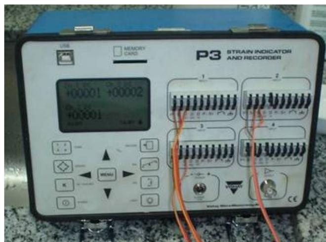
Figura 2. Indicador e gravador de microdeformações modelo P3-Vishay
