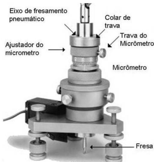
Figura 1. Sistema de fixação para usinagem do furo (Vishay Micro-Measurements Group, 2007)
