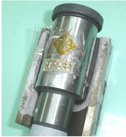
Figura 3. Corpo de prova com roseta retangular 062 RE-Vishay e respectivos terminais para instrumentação.
