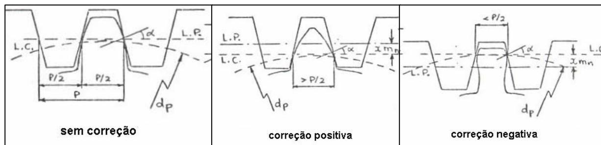
Figura 3. Conceito da técnica de correção de perfil.
