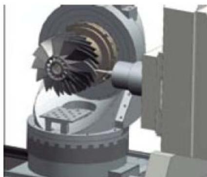
**Figura 19 - Representação de simulação de usinagem contemplando mecanismos de máquina ferramenta**
