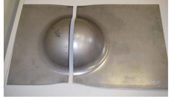
Figura 6. Final da primeira operação de estampagem. Comparação numérico-experimental entre as espessuras obtidas segundo o corte transversal (identificado no lado direito).
