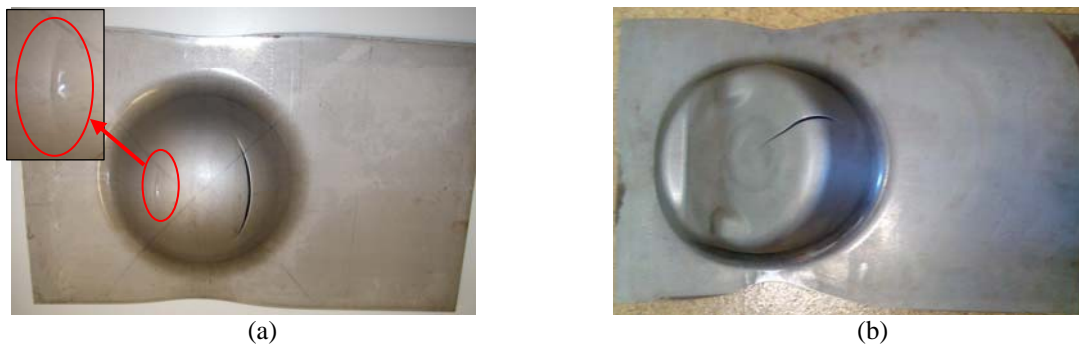
Figura 1. Componentes obtidos no final da (a) primeira e da (b) segunda operação de estampagem, exibindo fracturas.
