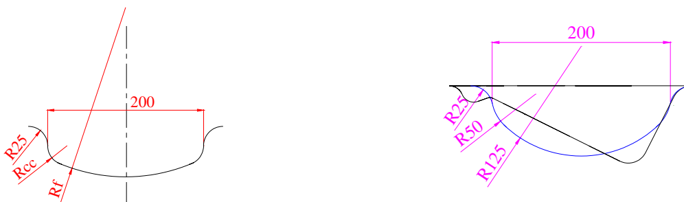
Figura 12. Geometria proposta para a ferramenta da primeira operação (lado esquerdo). Sobreposição das geometrias dos cunhos da primeira e da segunda operação de estampagem (lado direito).
