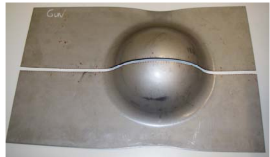
Figura 5. Final da primeira operação de estampagem. Comparação numérico-experimental entre as espessuras obtidas segundo o corte longitudinal (identificado no lado direito).
