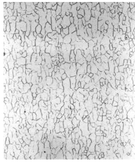
Figura 1. Aspectos da microestrutura do aço IF. Ataque com Nital a 4%. Ampliação: 200X (Luiz, 2005)
