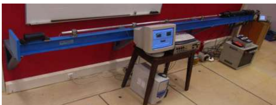
Figura 9. Barra de Hopkinson de impulsão electromagnética instalada no Instituto Superior Técnico.
