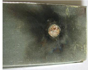
Figura 5. Parâmetros excessivos para a espessura da chapa (0,7 mm), teste BZ03
