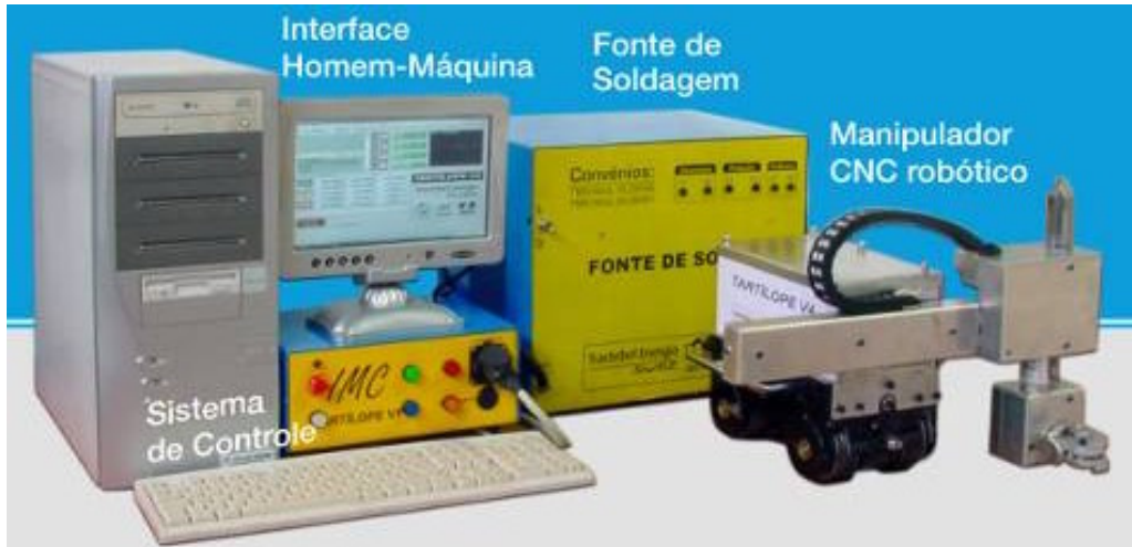
Figura 6. Componentes do sistema automático de soldagem.
