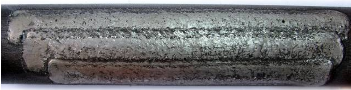
Figura 10. Tubo revestido com o processo PTAP.
