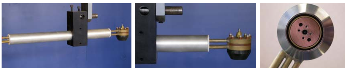
Figura 3. Tocha do PTA e o bocal de cobre com quatro pequenos orifícios de saída de pós.
