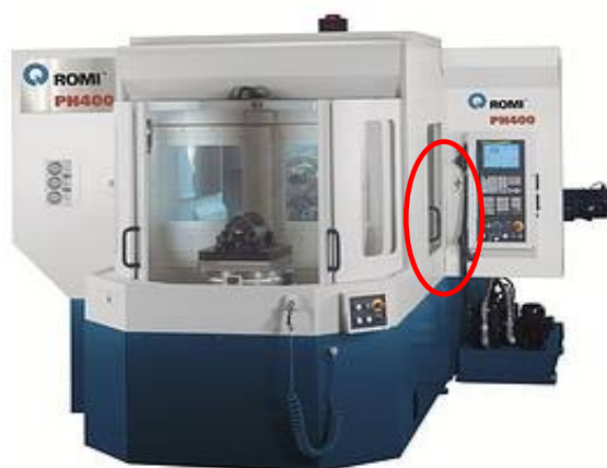
Figura 1. Sistema de setup de ferramenta em separado no Centro de Usinagem. (ROMI PH400, 2004)
