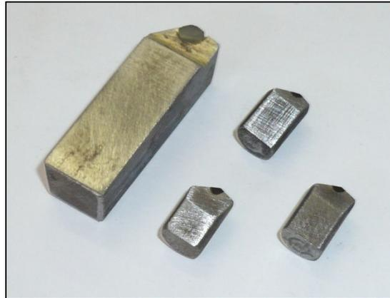
**Figura 2. Fotografia das ferramentas de wBN utilizadas nos ensaios de usinagem.**
