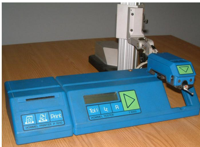
Figura 5. Perfilmetro Hommel Tester T1000<sup>®</sup>.utilizado para medição de rugosidade.
