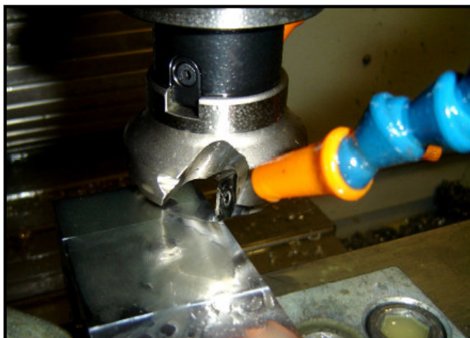
Figura 3. Fresa Mitsubishi ASX445-050A03R (esq) e o fresamento ao longo do eixo Y (dir)
