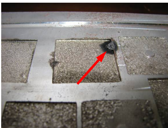
Figura 1. Depósito de grafite que anulou a diferença de potencial peça-eletrodo nos ensaios preliminares
