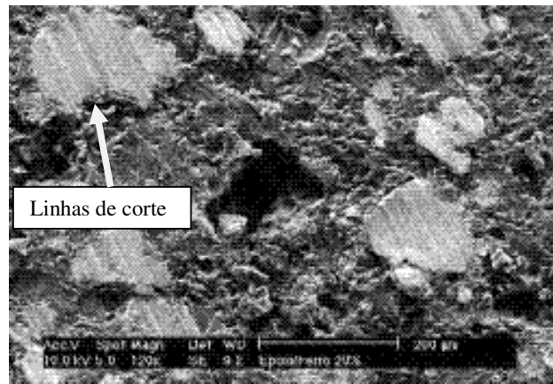
Figura 14. Microestrutura do compósito com 20% de ferro e aumento de 120x
