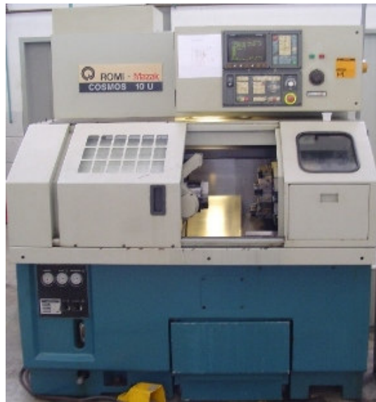
Figura 2. Torno CNC Romi Cosmos 10U usado nos ensaios na UFSC
