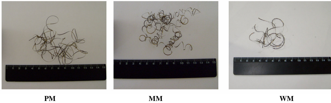
Figura 7. Cavaco obtido com V_c = 220 m/min, f = 0,1 mm/volta, a_p = 0,2 mm.
