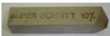
Figura 1. Ferramenta de HSS utilizada no teste VOLVO.
