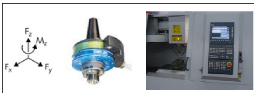
Figura 3. Dinamômetro Rotativo Kistler e Centro de Usinagem Romi.
