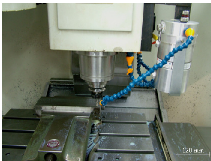
Figura 1. Imagem do ensaio de fresamento com aplicação de MQF.
