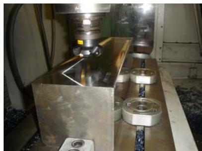
**Figura 2. Vista do material usinado fixado à mesa da máquina-ferramenta e do conjunto fresa/mandril.**
