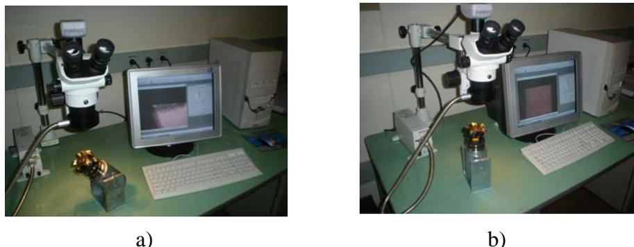
**Figura 3. Posicionamento do conjunto fresa/mandril para análise e medição do desgaste. a) Desgaste de flanco; b) Desgaste no chanfro.**
