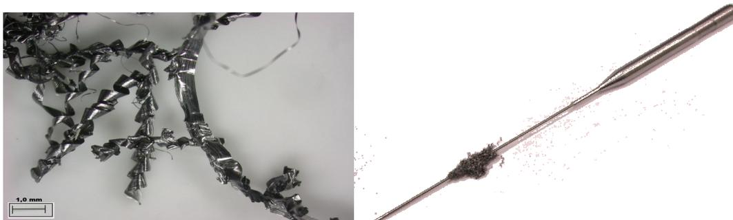
Figura 1. Cavaco tipo fita e helicoidal longo: ampliado (à esquerda) e enrolado na ferramenta.
