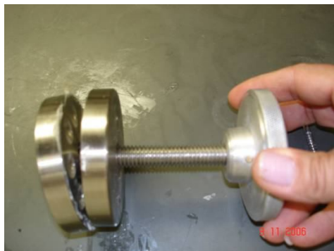
Figura 9. Parafuso extrator para abertura da matriz
