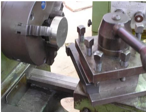
Figura 4. Faceamento em um torno mecânico marca Nardini 500 II Micro.
