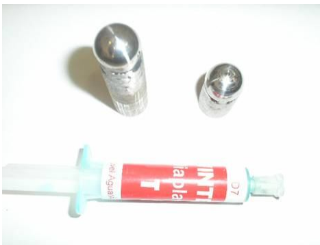
Figura 8. Pasta de diamante e ferramenta conformadora para polimento.
