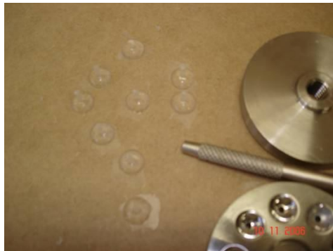
Figura 9. Botões de íris removidos da matriz após a polimerização.
