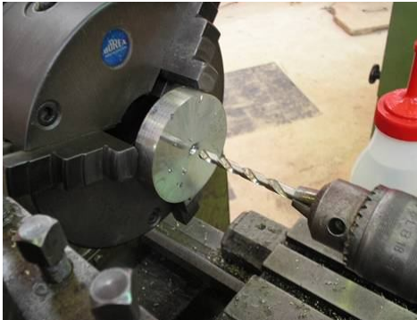
Figura 5. Furação em um torno mecânico marca Nardini 500 II Micro.
