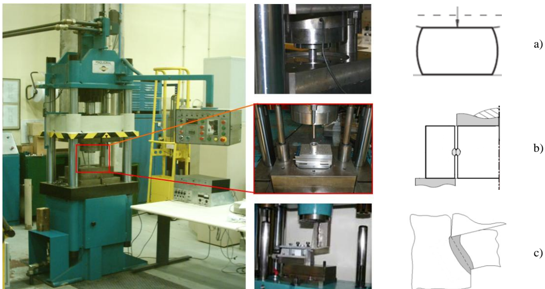
Figura 1. Prensa hidráulica de controlo numérico e ferramentas utilizadas no desenvolvimento experimental do trabalho. (a) Ensaio de compressão, (b) Ensaio de fractura, (c) Ensaio de corte ortogonal.
