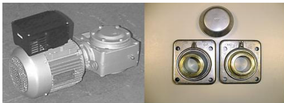
Figura 10. Motoredutor regulado através de variador de frequência e Mancal do Transportador
