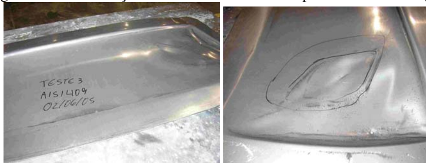
Figura 4. Chapa 3 após conformação. Foroni (2005).
