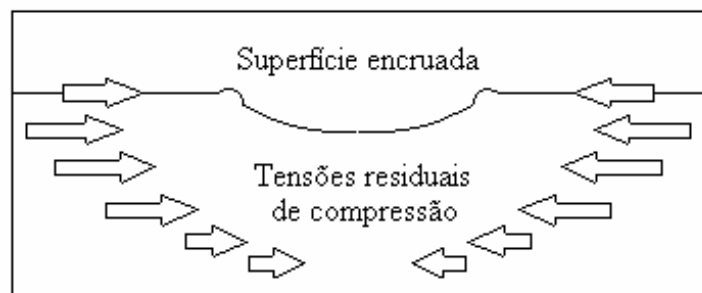
Figura 1. Tensões residuais de compressão geradas no processo de JCG
