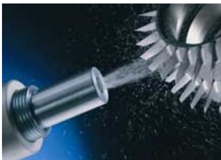
Figura 1. Tensões residuais de compressão geradas no processo de JCG
