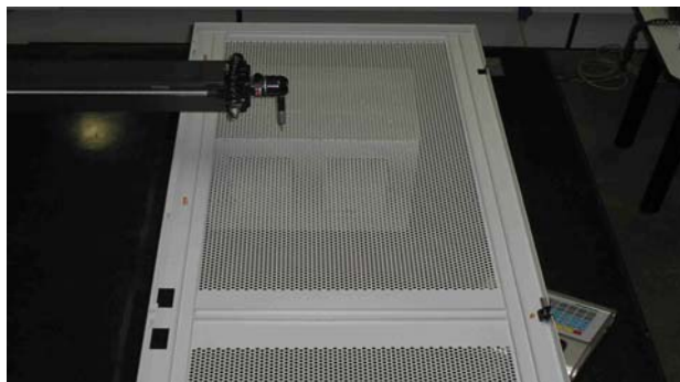
Figura 4. Medição da planicidade da porta perfurada acabada em tridimensional
